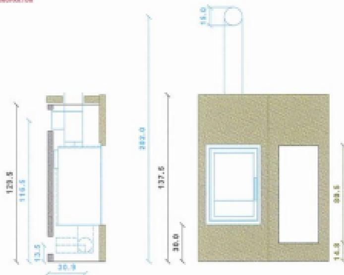
Verbrennungsluftzufuhr 120 mm ØM
